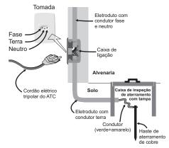
Esta figura acima é apenas uma ilustração de como funciona o sistema de aterramento, sendo o condutor terra ligado a uma haste de cobre devidamente fixada.
